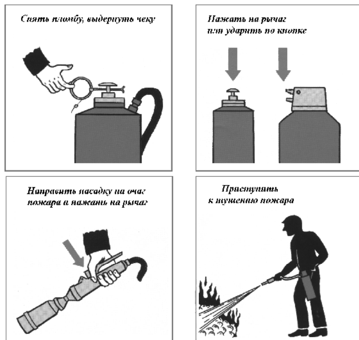
Рис. 9. Приведение в действие воздушно-пенного огнетушителя (плакат)
