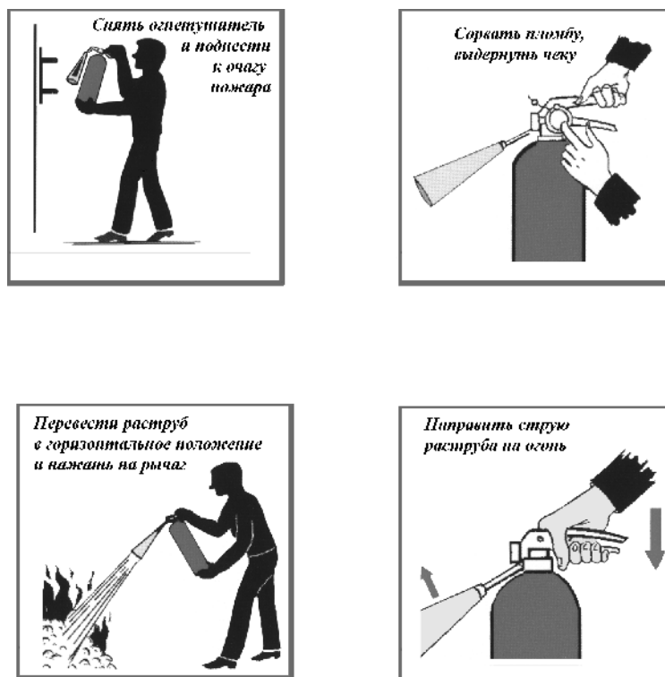
Рис. 8. Приведение в действие ручного углекислотного огнетушителя (плакат)
